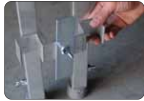
6. UNIÓN DE REFUERZO ENTRE 2 PIES(PERÍMETRO). 6. UNIÓ DE REFORÇOS ENTRE 2 PEUS(PERIMETRE).
